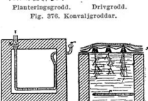
Fig. 372. Varmvattenbehandling av växter. Till vänster bassängsedd uppifrån. Till höger bassäng, fylld med vatten, i lodrät genomskärning. Nedtill värmeledningsöret r, upp till blomkrukorna ställda på ribbor, däröver halmmattor.
