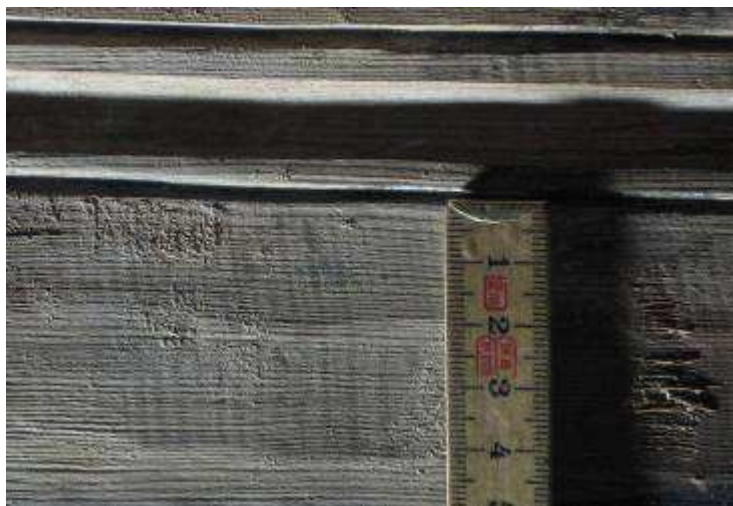
BILD 3. Hyvelspårbredd på drygt 20 mm. Av det täta spåren på tvären av fiberriktningen, ser man att stålet vibrerade under hyvlingen. Foto Robert Carlsson.
