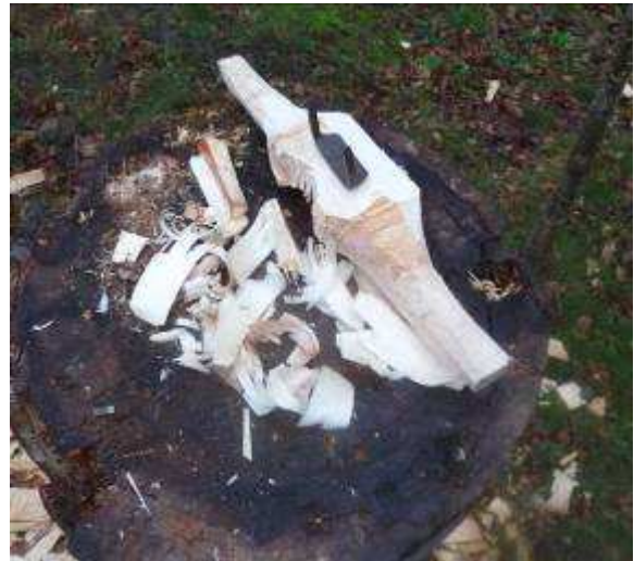
BILD 10. Det nu torra hyvelstocksämnet formas mer i detalj, exempelvis stålsäte, grepp och sprund. Foto Magnus Welin.
