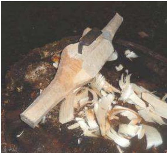
BILD 11. Ett mycket kritiskt moment – infästning av hyvelstålet. Foto Magnus Welin.
