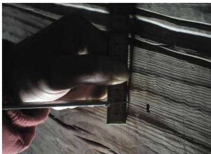
BILD 4. Hyvelspårets djup i detta fall, mättes med skjutmått till 0,8 mm. Foto Robert Carlsson.
