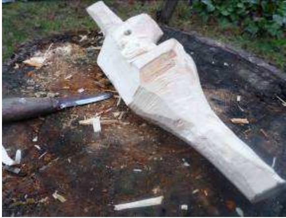
BILD 13. Härvidlag är stålets tångar grovt inpassade, nu gäller det att tälja fram den slutgiltiga formen. Foto Magnus Welin.
