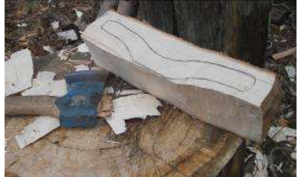
BILD 8. Det nyhuggna halvklövsämnet är uppmärkt efter mall. Foto Magnus Welin.
