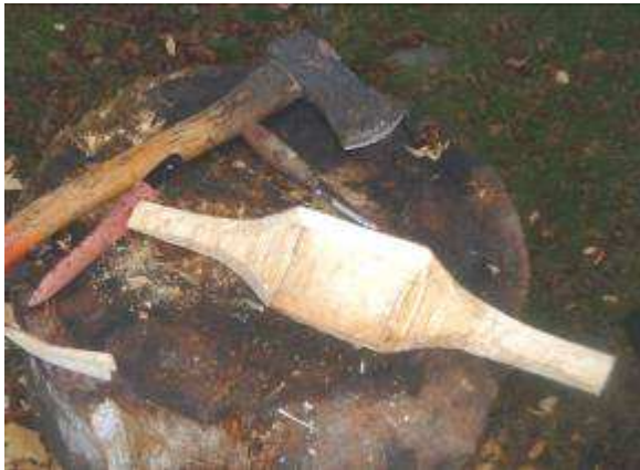
BILD 9. Ämnet formas grovt efter riter med yxa och kniv, därefter torkas det. Foto Magnus Welin.
