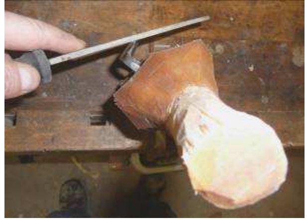
BILD 14. Nu återstår att fila och bryna fram en god gång hos hyveln – kort och gott att ställa in spånföringen. Lägg märke till att eggfasen ligger nära vinkeln på sulan. Foto Magnus Welin.
