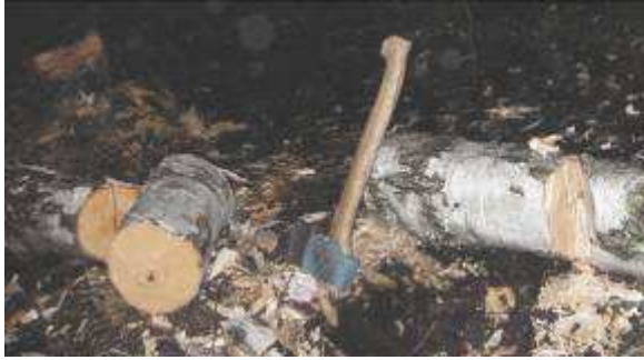
BILD 7. Fällning av björk och aptering till halvklövsämnen. Foto Magnus Welin.
