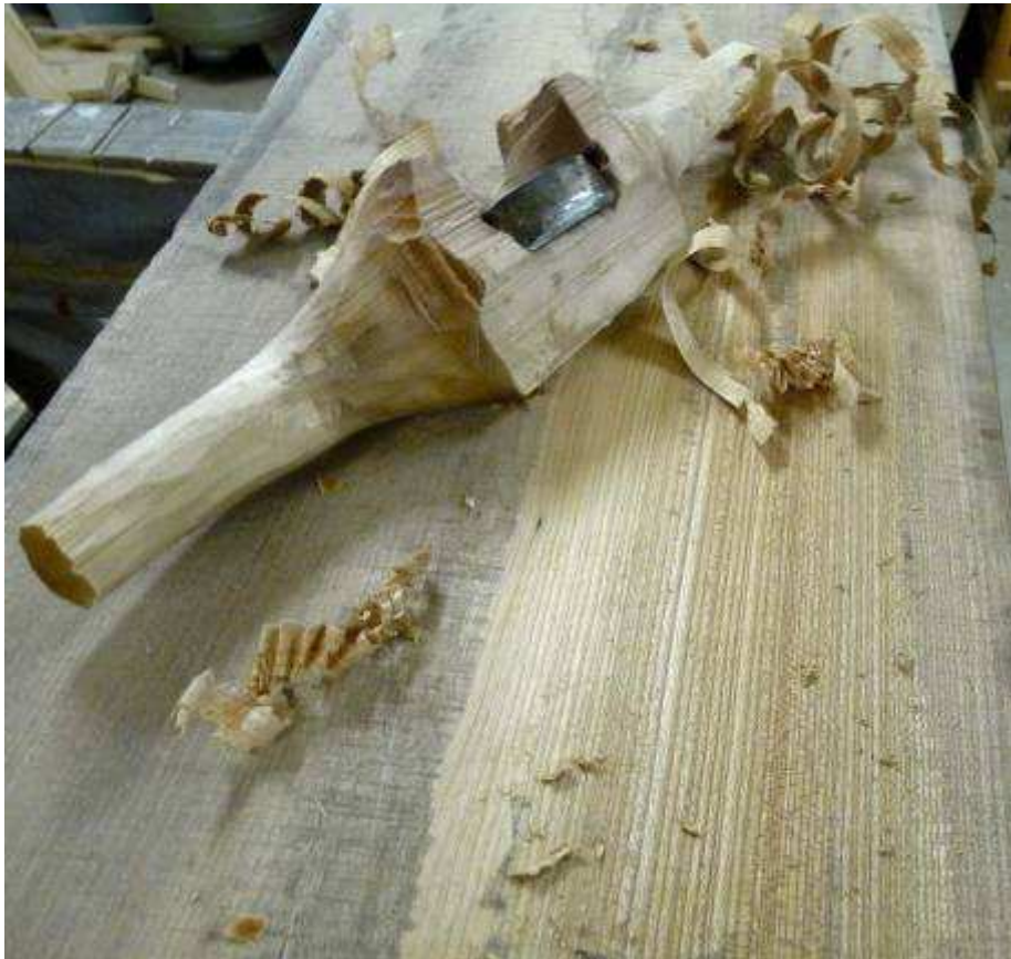
BILD 15. Hyvelns gång kontrolleras på en almplanka, med godkänt resultat. Foto Magnus Welin.
