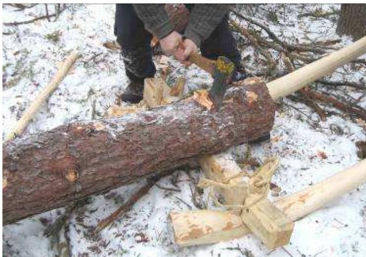
BILD 13. Roald hugger upp spåret där påbännevalen skall placeras och låsa fast stocken vid timmervagen. Foto Robert Carlsson.
