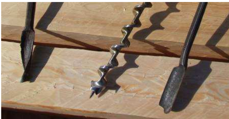
BILD 10. Tre typer av navare, från vänster räknat: norsk spiralnavare, spiralnavare med bottenskar och Södra Rådaprojektets skednavare med nos. Foto Södra Rådaprojektet.
