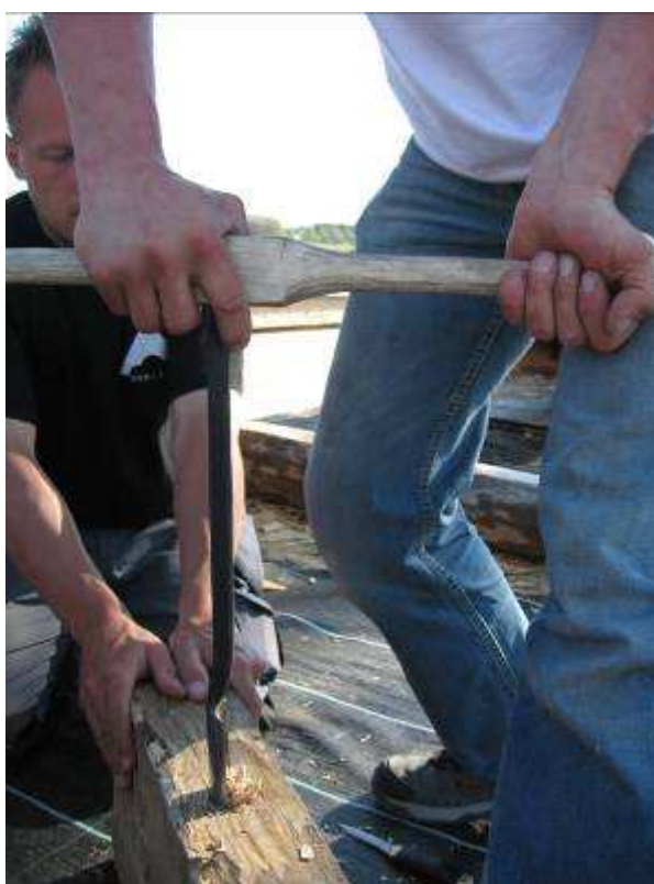
BILD 12. Smeden Bertil Pärnsten har en lektion i navarföring. Lagg märke till fattningen av navaren – en hand över navarens axel och en förande hand på greppet. Foto Robert Carlsson.
