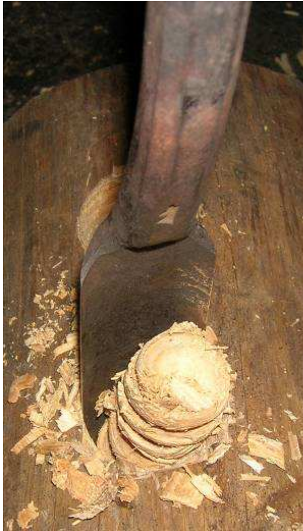
BILD 8. Navare på väg ned i timret. Lagg märke till den sammanhängande borrhålen. Foto Bertil Pärnsten.
