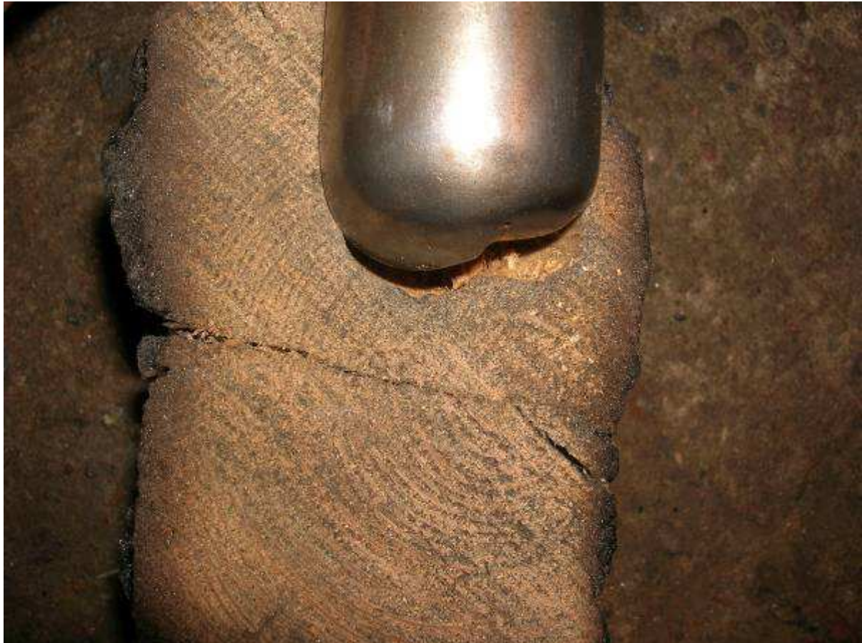
BILD 7. Ett itusågat brandfragment av ett väggtimmer med dymlingshål, visar den typiska hjärtformade hålbotten. Som synes stämmer de nytillverkade navarna mycket väl överens med originalspåren. Foto Bertil Pärnsten.
