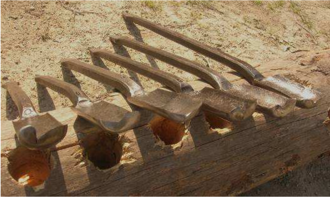
BILD 9. Nysmidna väggnavare från Bräcke smedja. Som synes är det ett antal olika utförande på nosen. Foto Bertil Pärnsten.
